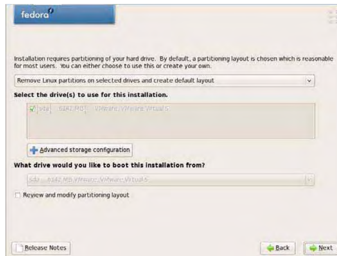
Gambar 4.18. Proses penentuan target instalasi.
