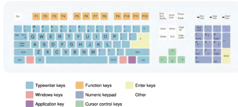
Gambar 3.19. Skema umum sebuah keyboard.
