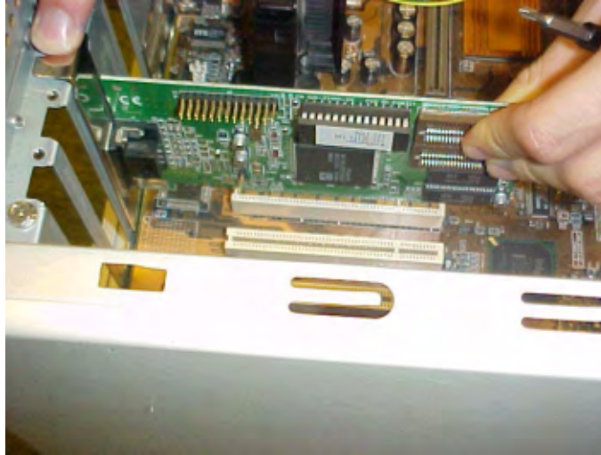
Gambar 3.15. Pemasangan expansion card.
