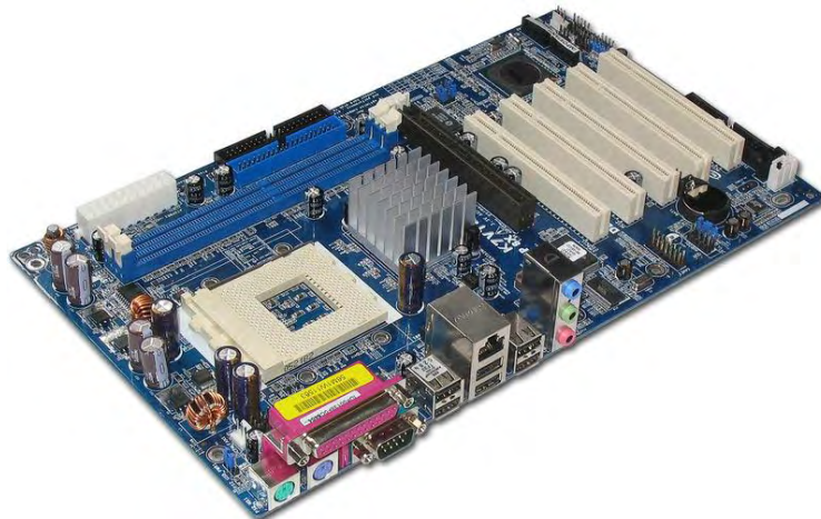
Gambar 4.6. Motherboard sebuah komputer.
